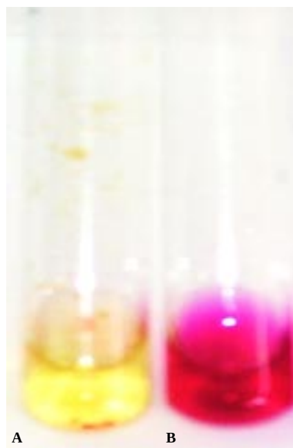
Figura 3. Reacción colorimétrica de los métodos: A) Ogata 1972 y NIOSH 1994, B) Nuevo método 2006. La diferencia de color es evidente. La reacción colorimétrica con el método de Astudillo es de un rojo profundo
